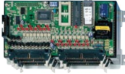
当社のハイアンプ制御エレベーターは双方向性サイリスタの移相制御により、かご形高抵抗誘導電動機の回転を周波数に変換して、パルス幅の変化を帰還増幅器に入力し、半サイクル用サイリスタの点弧角を制御し、電動機の回転を必要に応じ制動して、減速を円滑に行わせ、かつ短縮した時間で着床を確実に行わせるために開発されたエレベーターであります。したがってとてもなめらかな加速とソフトな減速を実現しました。
